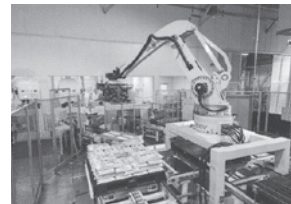
ロボットパレタイザー ● 袋詰めされた製品を自動でパレットに積みつけていきます。
