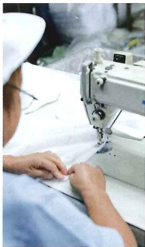
▲タオルの両端にミシンをかけていく。折り目ギリギリのところを素早く縫っているのは、まさに職人技
